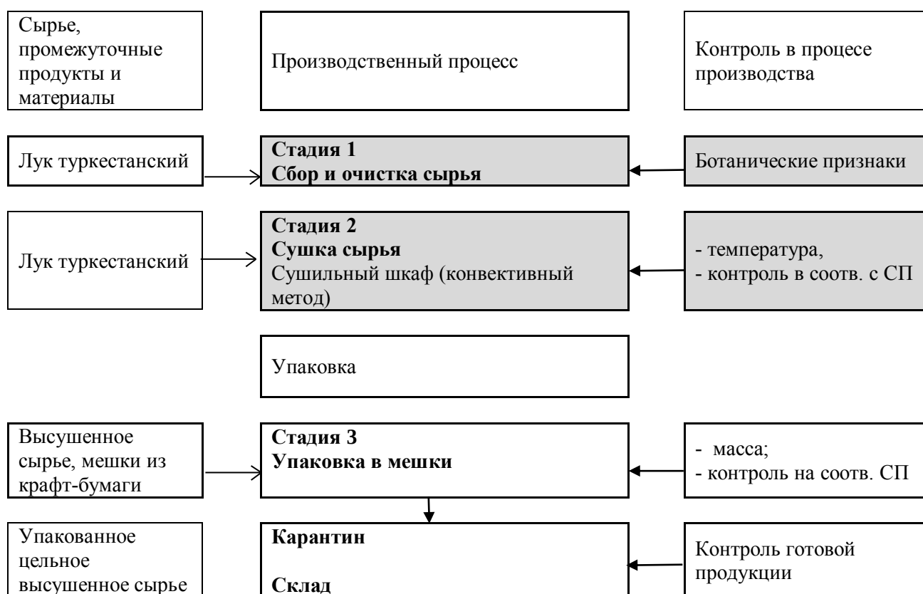
Рисунок 2 – Технологическая схема заготовки и сушки лука туркестанского
